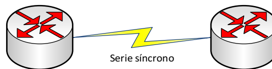
Figura 11.2. Ejemplo de enlace mediante línea dedicada.
