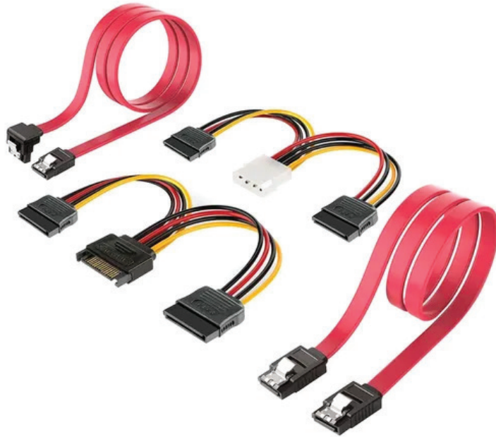
Figura 1.8. Contar con cables adicionales en la línea SATA y Power SATA es una ventaja. A veces los fabricantes de placas madre incluyen una sola unidad, y necesitas tener un cable extra en caso de que tu cliente requiera más de un medio de almacenamiento.
