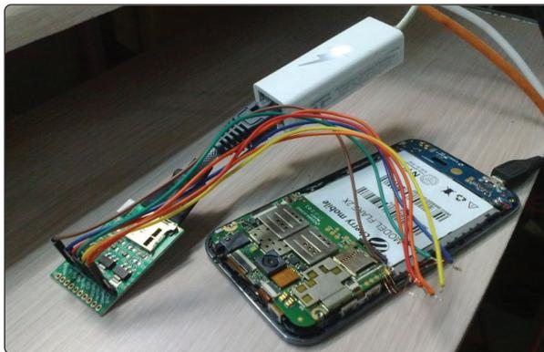
**Ilustración 8.** Ejemplo de JTAG para la obtención de datos de un dispositivo móvil.
