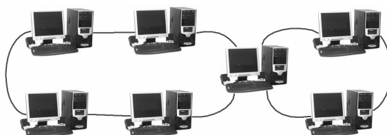
Figura 1.7. Red con topología en intersección de anillo
